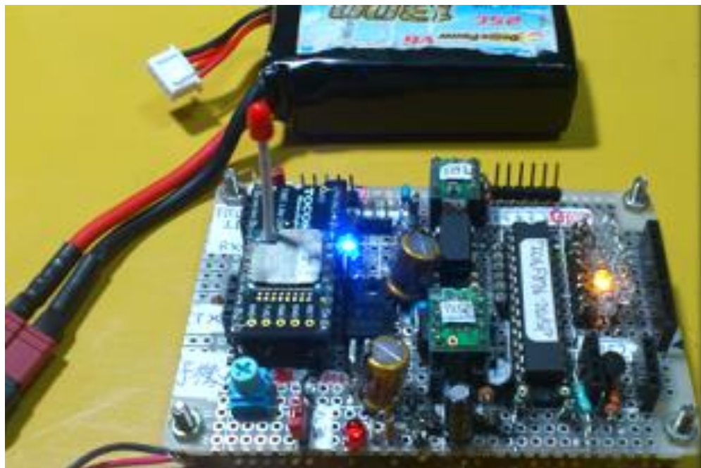
磁気(磁束密度)の計測と磁気偏角計算・データ送信部
