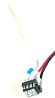
探知対象発振器 1MHz, 矩形波 PIC12F1822 DSM 機能利用 DSM: Data Signal Modulator
