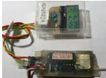
I2Cコネクタを装備したのでLCDディスプレイを用い、現場で容易に動作確認できる。
