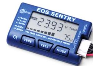
電気残量測定に用いたチェッカー Hyperion バッテリーチェッカー EOS SENTRY2
